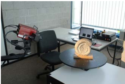
Aufbau Scanner, Laptop, Drehtisch
